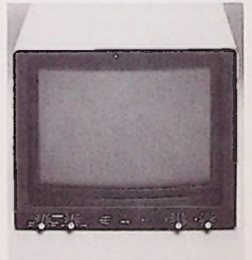
Bild 1: Monitor mit nichtlinearem Grauwertexpander
