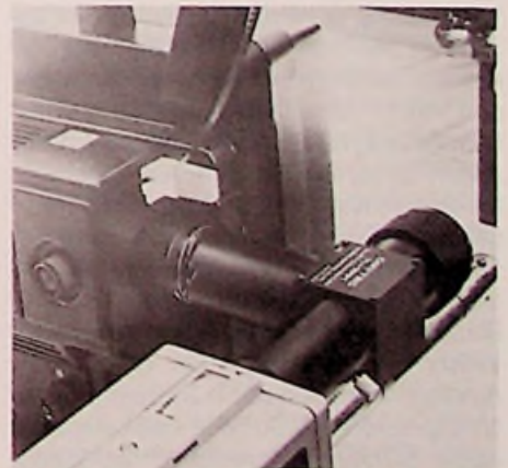
Bild 6: JVC-Konverter TL 1001 zum Mischen eines bewegten Filmbildes mit einer ruhenden Positiv-Vorlage
