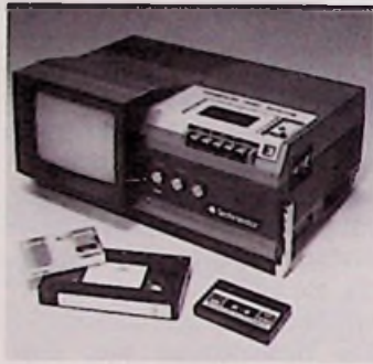
Bild 1: CVC-Recorder mit integriertem Farbfernsehgerät
