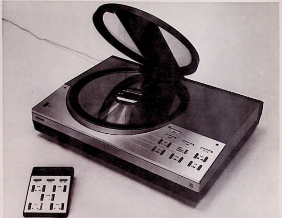
Bild 1: Bildplattenspieler VP 720 mit IR-Fernbedienung (Philips-Pressebild)
